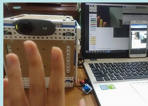
將C310網路攝影機與樹莓派連接，使用Python編寫程式，顯示攝影機所拍到的畫面，若是使用電腦或手機與樹莓派遠端連線，即可達到遠端視訊監控。
