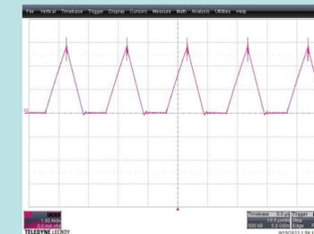
電感  $L_1$  電流波形，工作於DCM 電感  $L_2$  電壓與電流波形，工作於CCM
